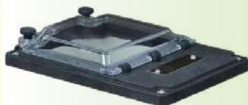
Der Standard für Temperaturregler aus PA66 mit transparentem Polycarbonat-Fenster für Anwendungen, die einen häufige(n) Zugang oder Einstellung erfordern, ohne elektrische Gefahr: Kein Zugang zum Anschlussblock bei offenem Fenster.
